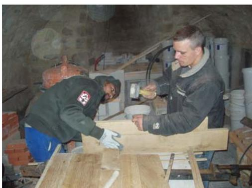
L'assemblage des volets consistait à calibrer les volets à la côte demandée par rapport au plan et à défoncer les traverses qui maintiennent les lames de volets pour après les clouer à chaud et poser les pentures. Ces volets s'ouvrent sur l'intérieur de la pièce et ferment sur les vitrages fabriqués et posés par Gauthier. Nous n'avons plus qu'à jointoyer le contour des fenêtres et faire le grand nettoyage pour l'inauguration qui se déroulera le samedi 10 décembre 2011.
