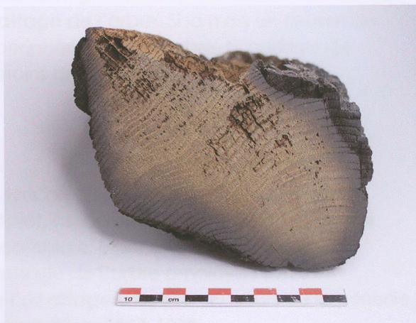
Fig. 2 - Coupe transversale surfacée de l'échantillon dendrochronologique prélevé dans la pièce carbonisée.
