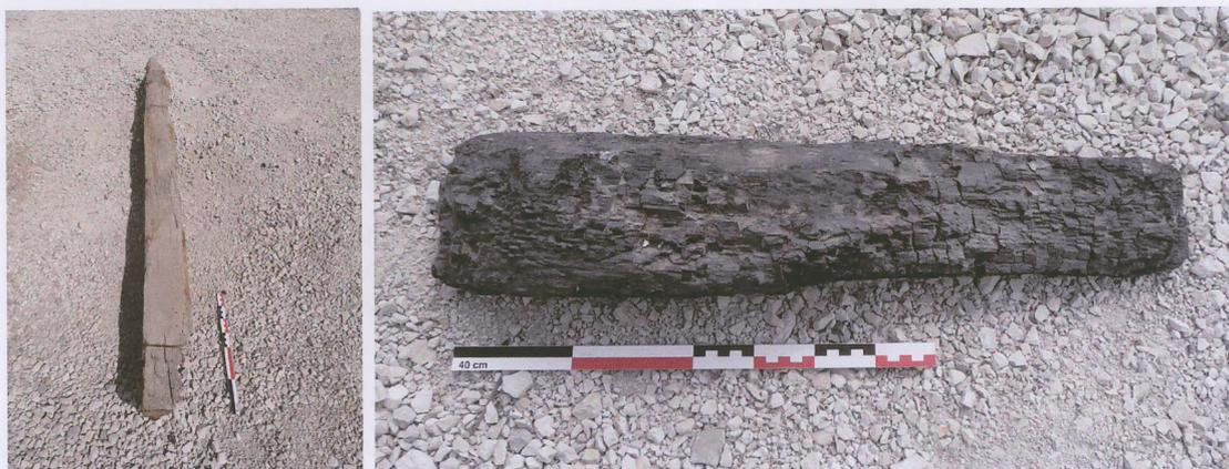
Fig. 1 - Sablière encastrée dans les maçonneries du 2<sup>e</sup> étage de la tour. Tronçon incomplet d'une poutraison carbonisée.
