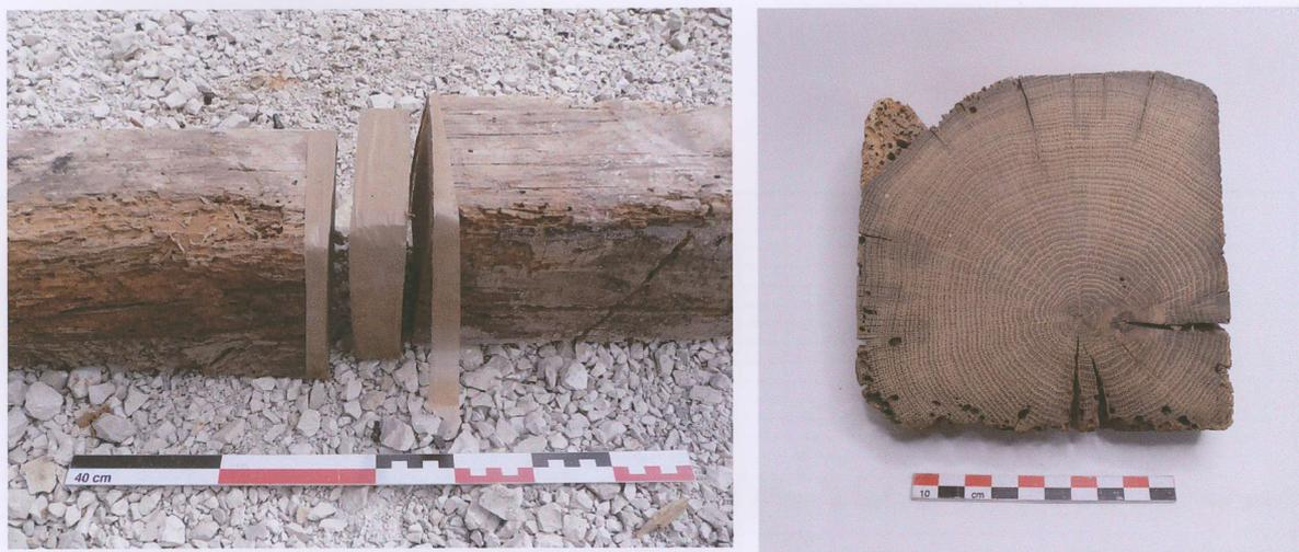
Fig. 3 – Echantillonnage dendrochronologique de la sablière encastrée, par tronçonnage manuel d'une rondelle conservant les cernes périphériques et l'assise cambiale de l'arbre - Coupe transversale surfacée de l'échantillon prélevé.
